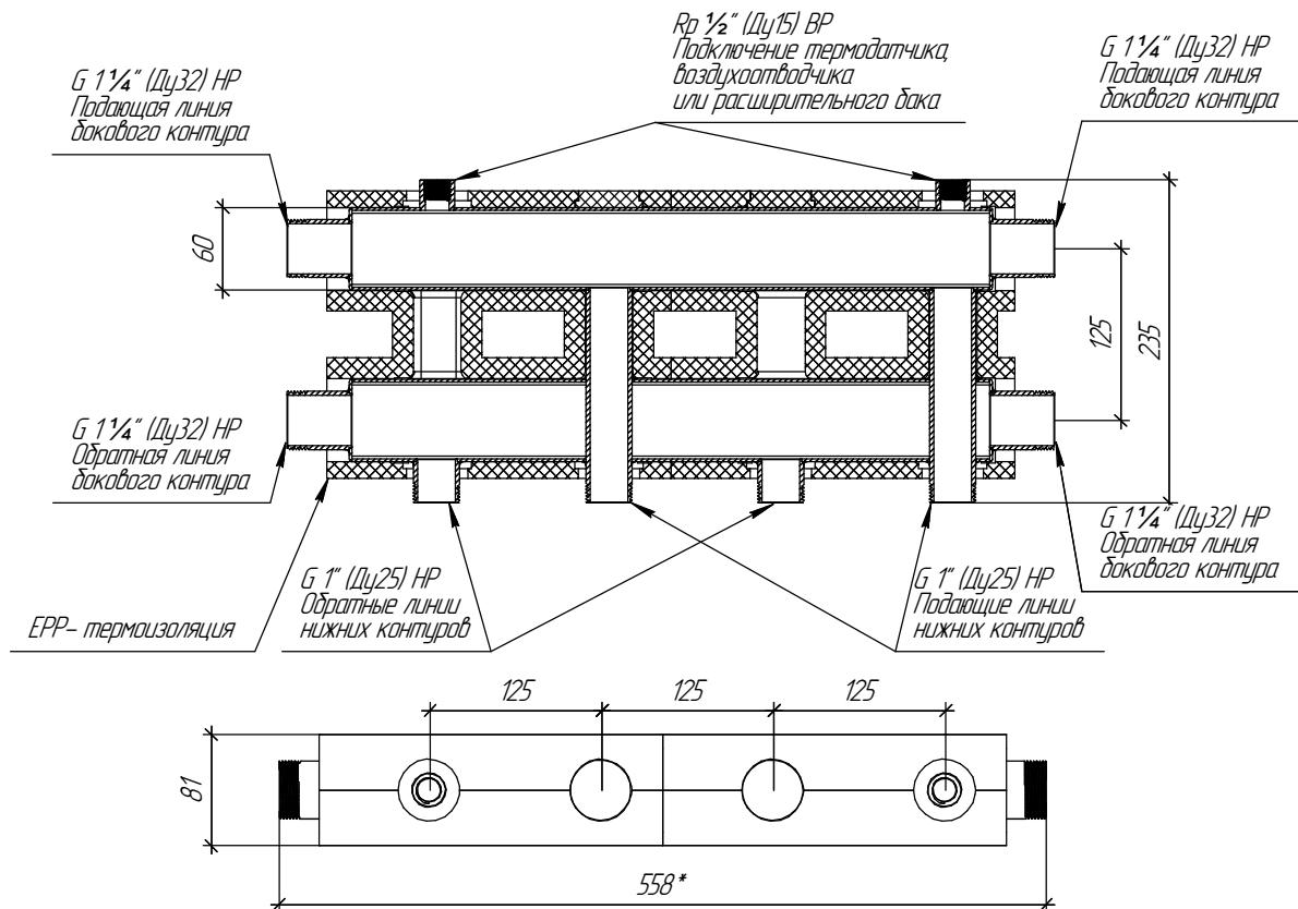
\* Используется для разметки отверстий кронштейнов (см. инструкцию K.UMS)
